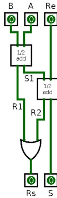
Chaînage des additionneurs 1 bit :
