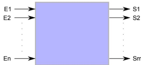
Boîte noire dont les sorties  $S_i$  ( $i \in \{1, \dots, m\}$ ) ne dépendent que des entrées  $E_j$  ( $j \in \{1, \dots, n\}$ )
