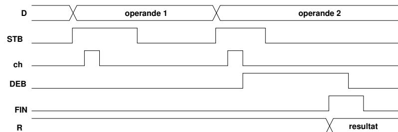
On se propose de réaliser la partie « contrôle du calcul ». Donner un diagramme d'états et réaliser ce circuit à l'aide de bascules « D » :
