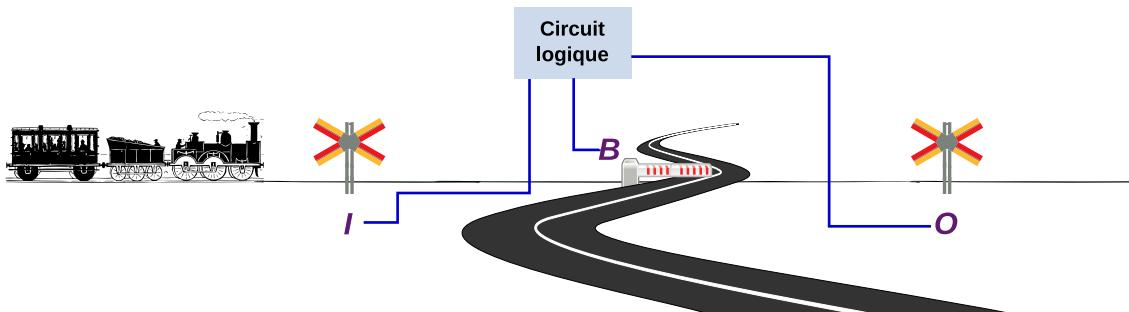
Deux capteurs  $I$  (entrée) et  $O$  (sortie) signalent l'entrée et la sortie d'un train; les signaux  $I$  et  $O$  durent exactement 1 cycle pour le passage d'un train; il peut y avoir au maximum 2 trains entre les points  $I$  et  $O$ ; un train peut entrer alors que simultanément un autre sort; le passage à niveau doit être fermé s'il y a au moins un train entre  $I$  et  $O$  en envoyant le signal 1 sur la sortie  $B$ .
