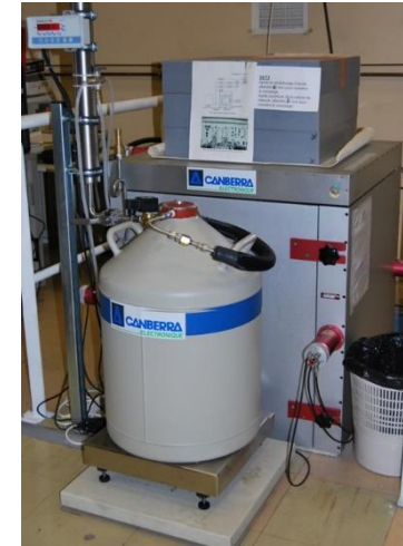
Chaîne de mesure HPGe (source : CEA/LNHB)
