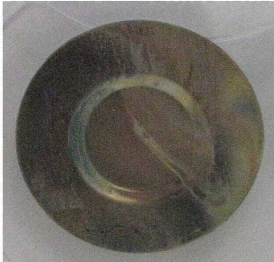
Dépôt de solution organique TBP 30 % dans TPH sans dilution
