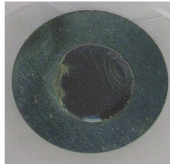
Dépôt de solution organique TBP 30 % dans TPH avec dilution \text{CH}_3\text{CH}_2\text{COOH}
