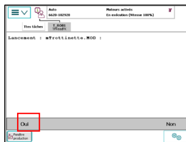
Bouton poussoir départ cycle et lancement du programme
