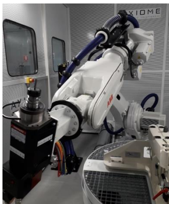
Robot en position pour le changement d'outil
