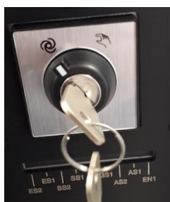
Sélecteur en position auto et écran de validation du passage en automatique
