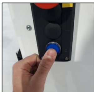
Bouton poussoir départ cycle et lancement du programme
