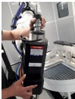
Robot en position pour le changement d'outil
