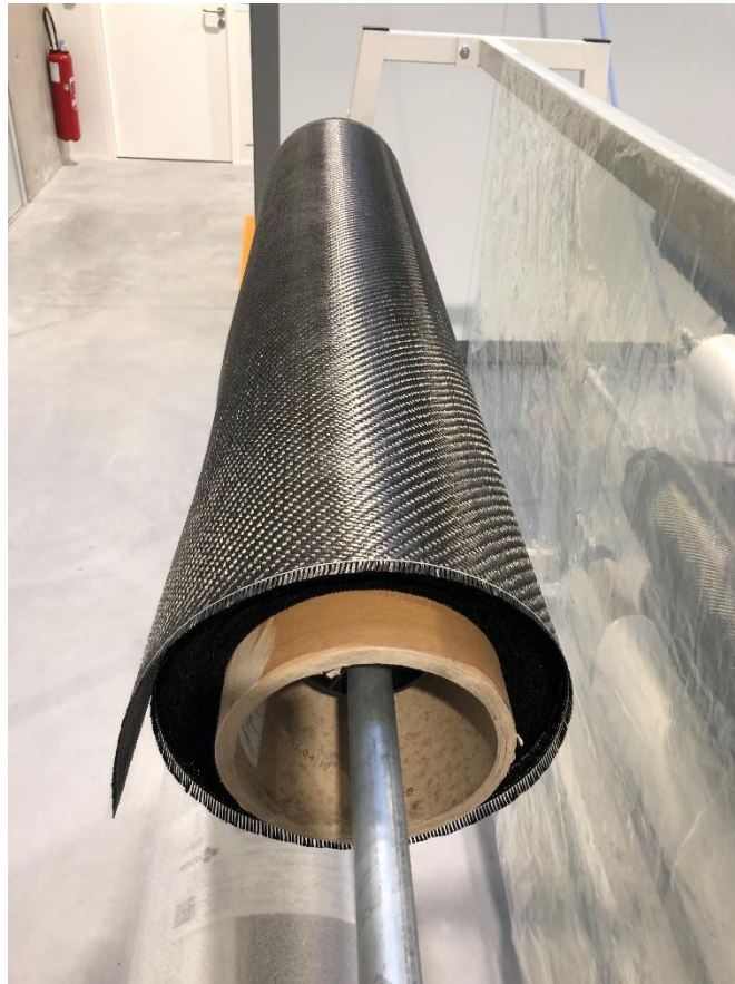
Figure 3 : photo du rouleau de carbone 600gr/m 2 0°/90°
