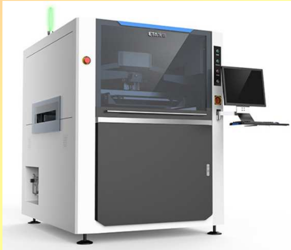
Machine de dépôt de pâte à braser
