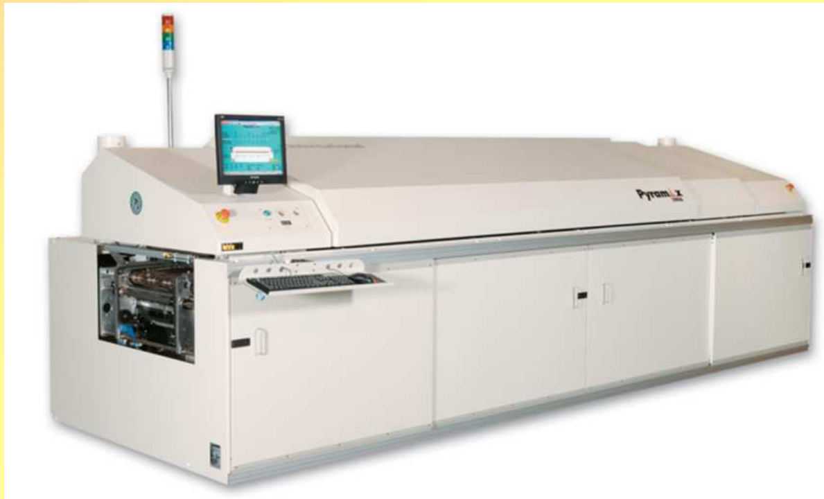
Exemple de four de refusion de composants CMS
