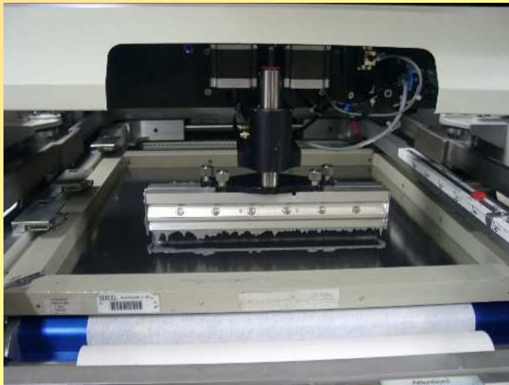
Exemple intérieur de machine de sérigraphie
